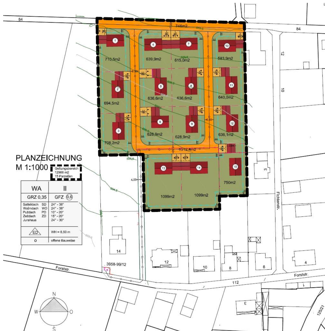
Abbildung 2: Übersichtskarte des Geltungsbereichs des geplanten Wohngebiets (ca. 1,3 ha WA, Ausschnitt aus dem BBP-Vorentwurf VE-12.12.2014/29.01.2015).
