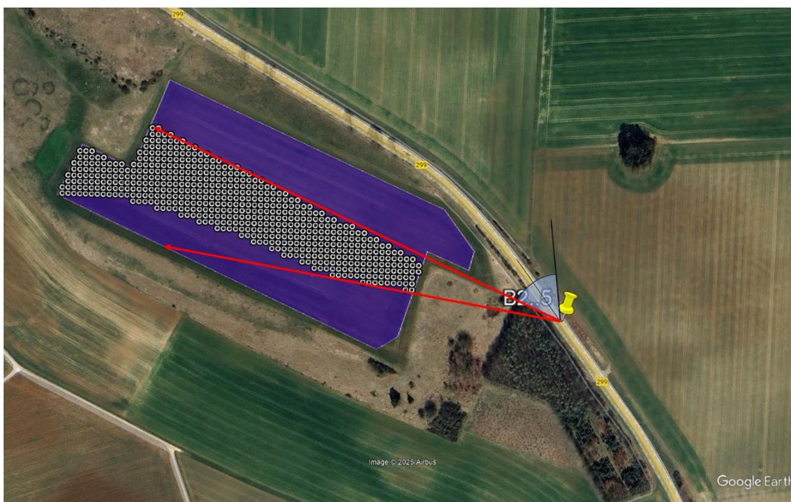
Abbildung 13: Vergleich Sichtfeld Fahrzeugführer für Punkt B2,5 mit Grenzvektoren in Richtung Module
