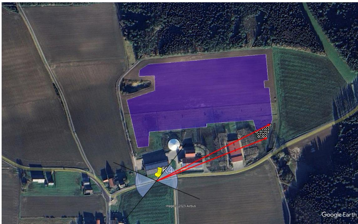
Abbildung 25: Vergleich Sichtfeld Fahrzeugführer für Punkt K4 mit Grenzvektoren in Richtung Module
