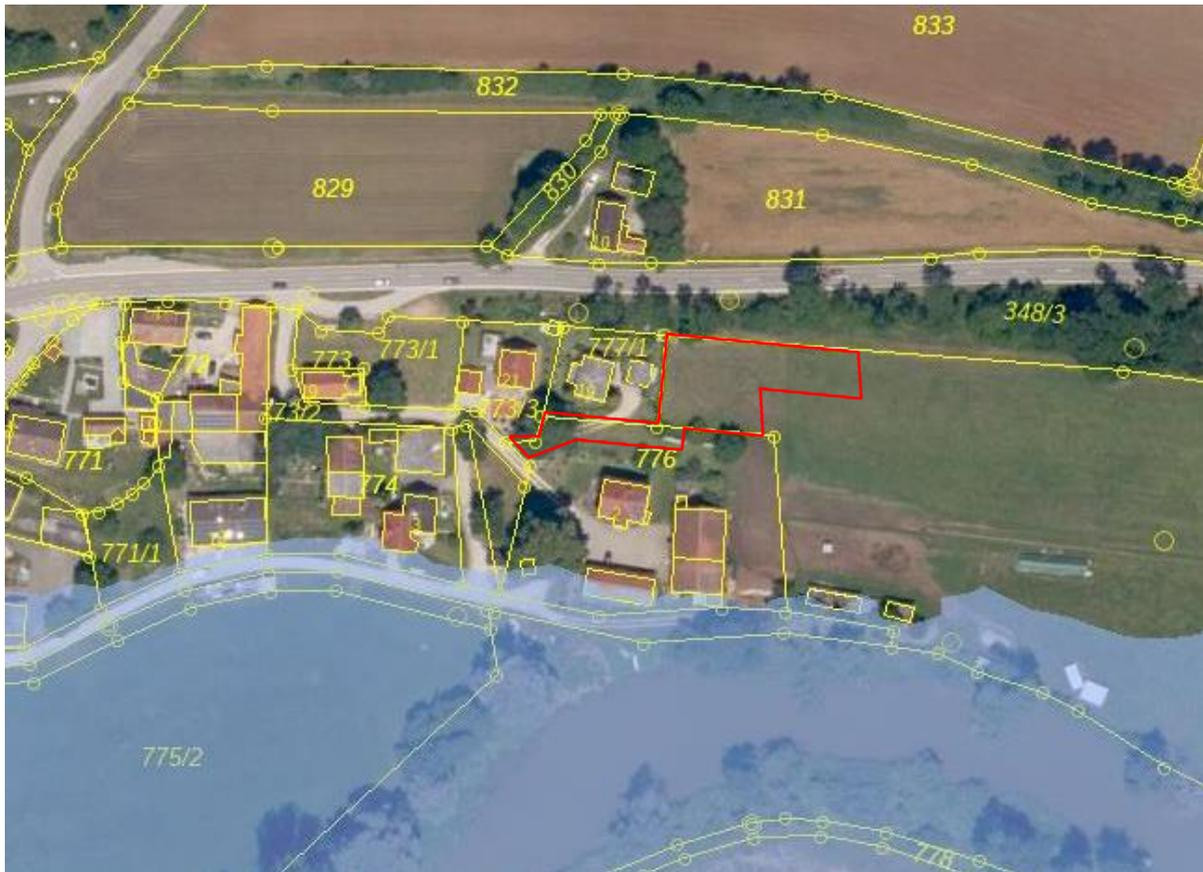
Abbildung 3: Hochwassergefahrenflächen HQ100, Einbeziehungsfläche in Rot, ohne Maßstab
