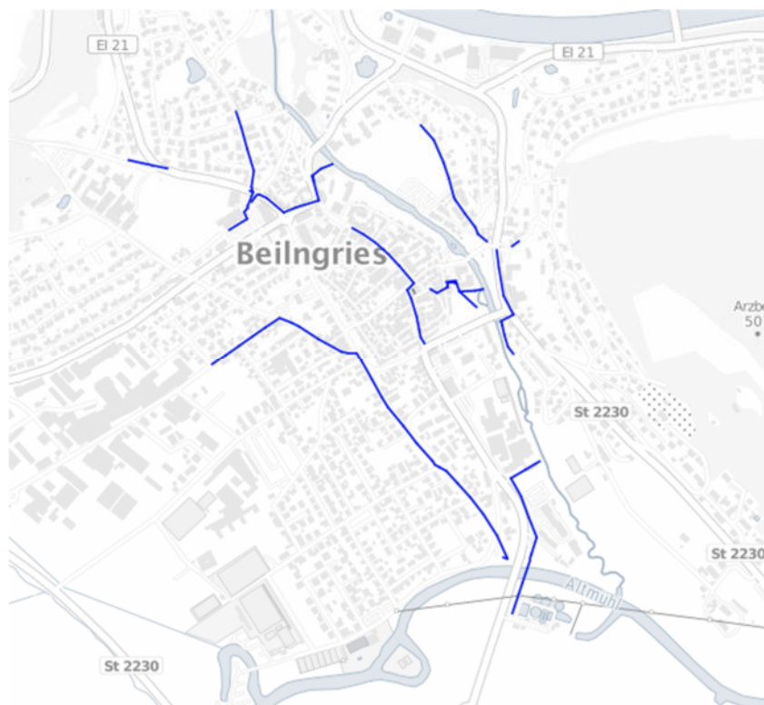
Abbildung 51: Abwasserstränge > DN800 (Veröffentlichung nach WPG, Anlage 2. I.)
