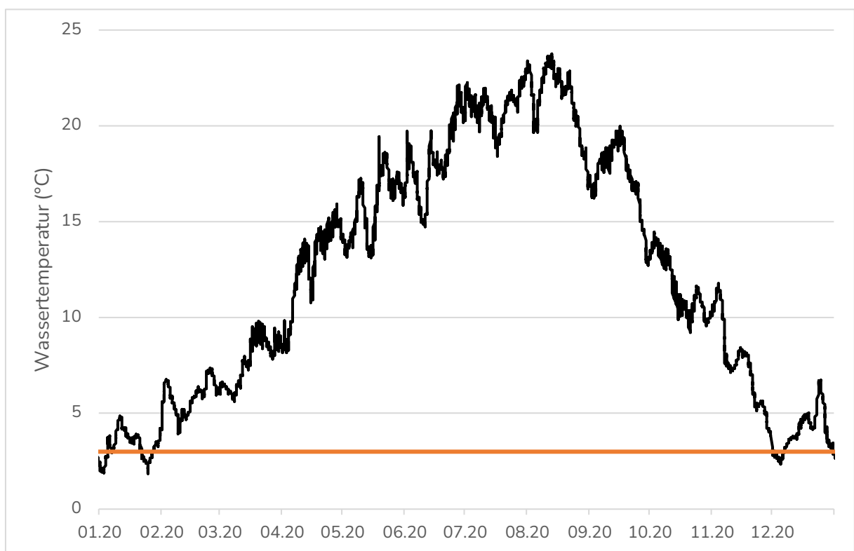
Abbildung 44: Wassertemperaturen in der Kanalhaltung Dietfurt im Jahr 2020
