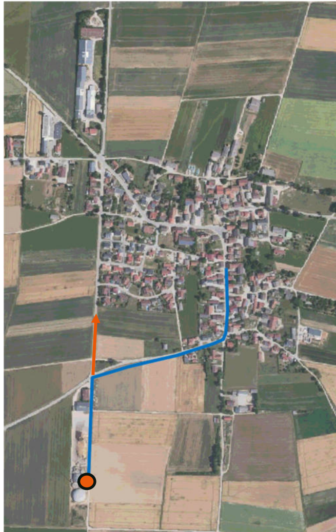
Abbildung 66: Fokusgebiet C) „Kevenhüll“ mit Biogasanlage und Bestandswärmeleitung (blau)
