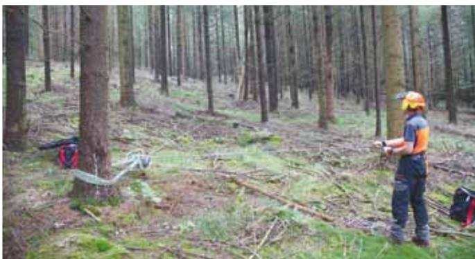
Foto 1: Ein sichere Alternative, wenn das Holz stimmt: Mit einer Spillwinde können hängen gebliebene Bäume unverzüglich und fachgerecht zu Fall gebracht werden.
