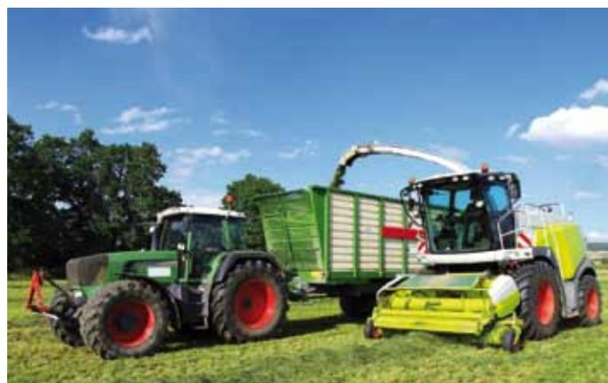
*Rechtzeitig vor der Ernte sollten ältere Feldhäcksler-Modelle sicherheitstechnisch nachgerüstet werden. Neue Modelle verfügen in der Regel schon über eine automatische Abbremsung der Häckselorgane oder vergleichbare Sicherheitseinrichtungen. Foto: SVLFG*
