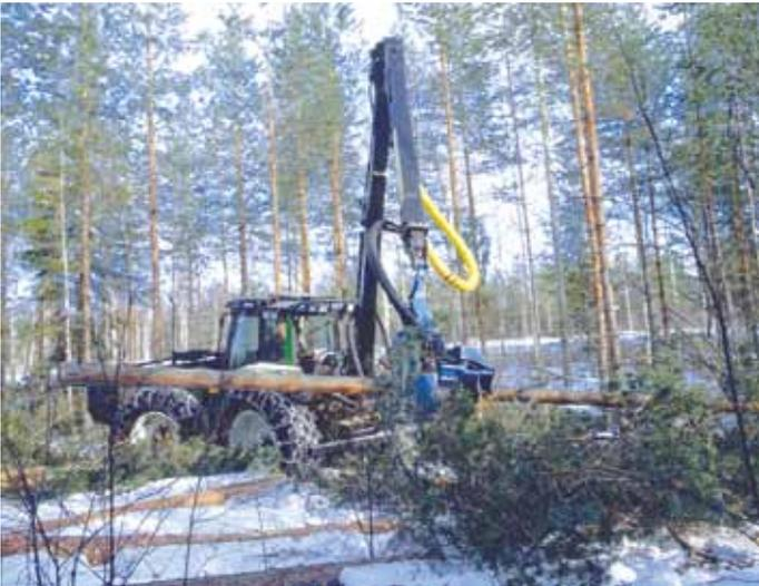
*Dort wo es möglich ist, sollte Sturmholz mit forstlichen Großmaschinen, wie zum Beispiel einem Harvester, sicher aufgearbeitet werden. Foto: SVLFG*
