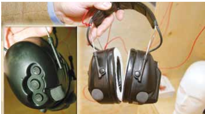
Kapselgehörschutz kann an den Helm montiert werden. Aktive Geräte schließen Lärm zuverlässig aus und ermöglichen trotzdem die Kommunikation mit Kollegen.
